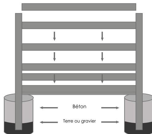
Schéma d'installation des poteaux dans les anneaux béton. Couler le béton autour du poteau de façon à ce que la base du poteau soit en contact avec la terre ou idéalement sur un lit de gravier.
