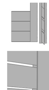
Fixer chaque lame aux 2 extrémités dans les poteaux avec des vis inox A4 (pré-percer).
