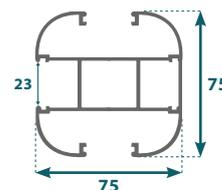
Pose sur muret: Max 1,10 m sur platine - Pose scellée: Scellement de 40 cm pour poteaux de 2,30 m
