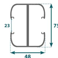
Pose sur muret: Max 1,10 m sur platine - Pose scellée: Scellement de 40 cm pour poteaux de 2,30 m
